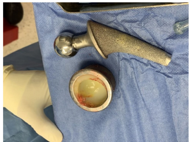
Figura 7 Fractura en la interface zona porosa-zona lisa del vástago.
